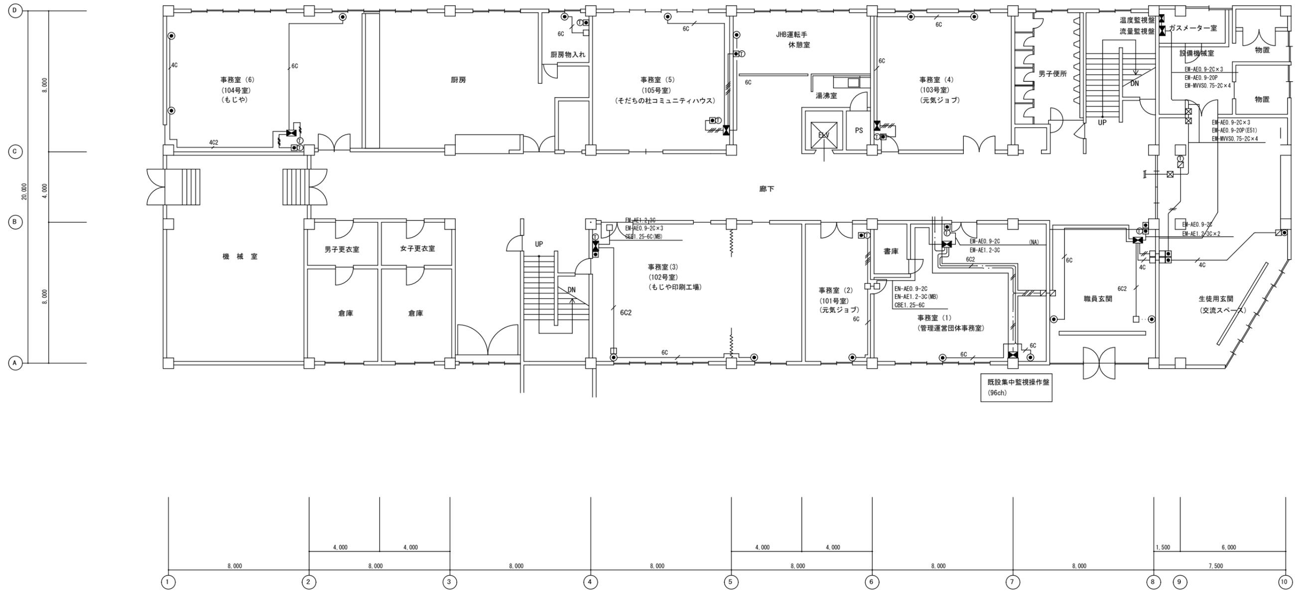
1階ガス暖房制御平面図 S=1/100 (既設) (改修)
